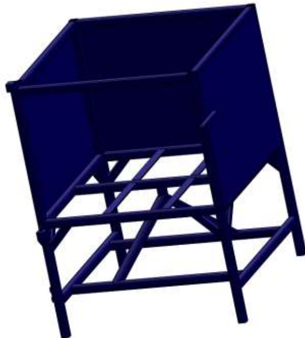
Figura 22. Recubrimiento externo de seguridad, vista de la estructura con placas.
