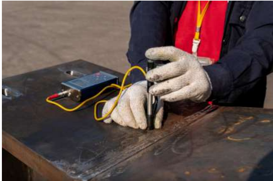
Figura 3. Operario inspeccionando la dureza del material con un durómetro Leeb portátil [24].
