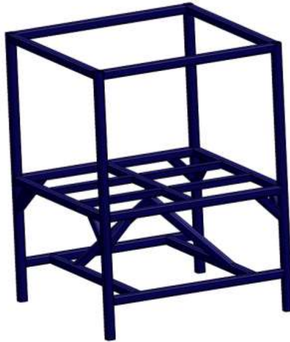
Figura 21. Estructura de soporte del horno, vista de la base principal.
